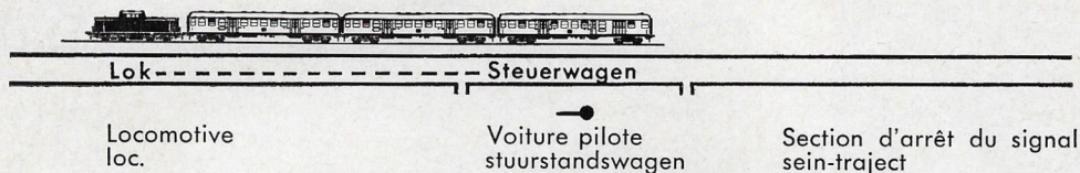
Situation dans le cas où la voiture pilote prend le courant quand la locomotive pousse le train. Situatie bij stroomafname door de stuurstandswagen wanneer de trein wordt geduwd.
